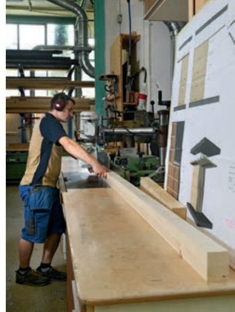
^ Il taglio e la lavorazione degli elementi si basa sull'interpretazione di piani 3D.
